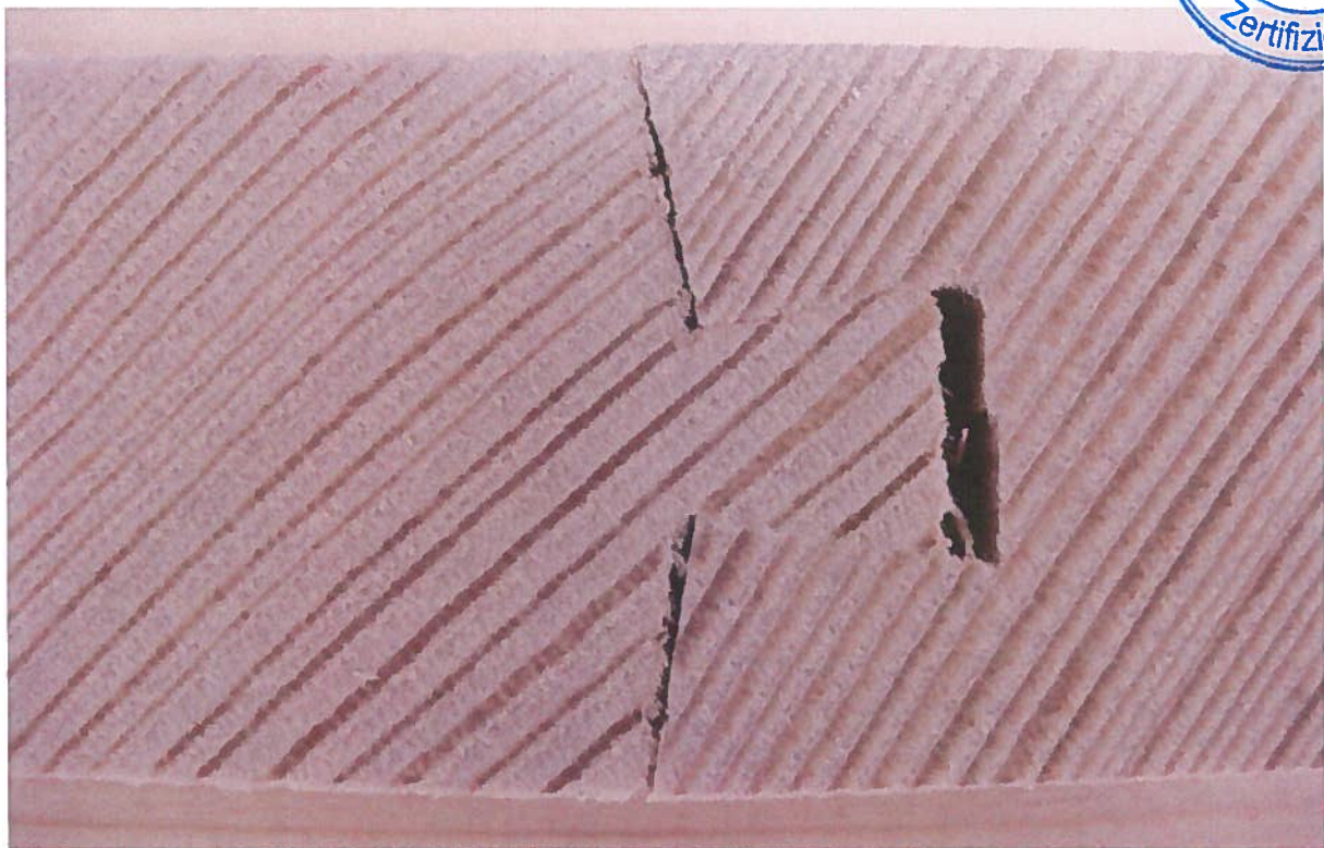
Bild 12: Schnitt durch eine Schwalbenschwanzverbindung
