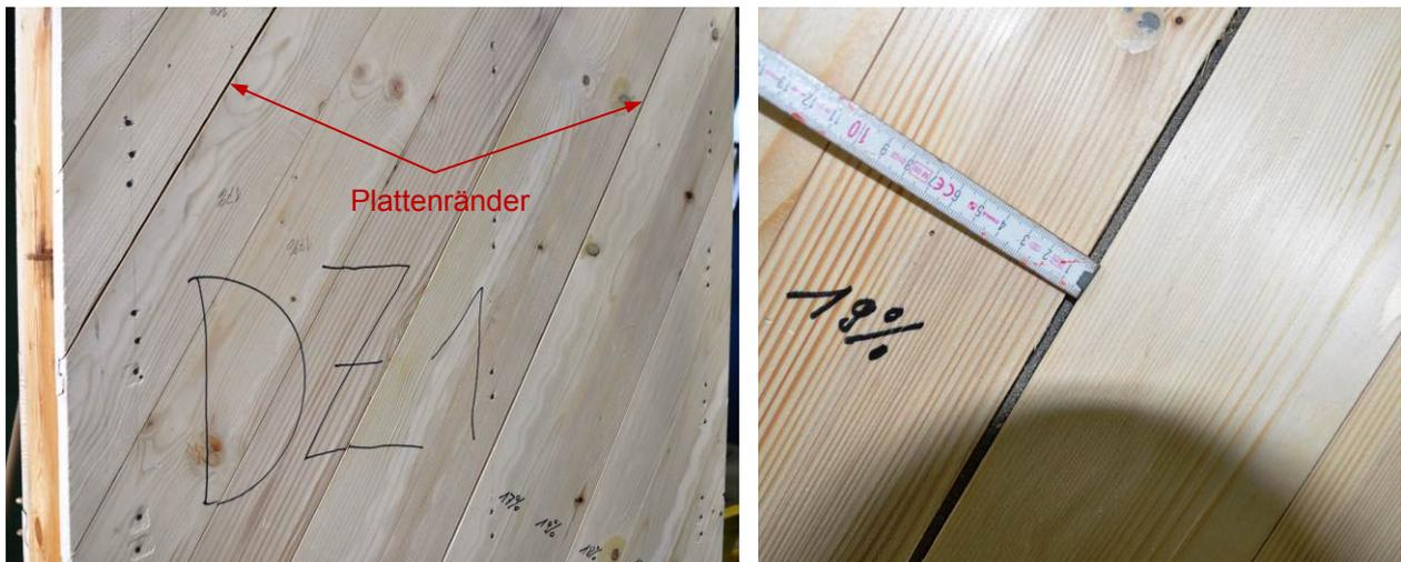
**Bild 10** Prüfkörper DZ1 vor Versuchsbeginn: Fugen zwischen den Brettern der Beplankung (links) und Detailaufnahme (rechts)
