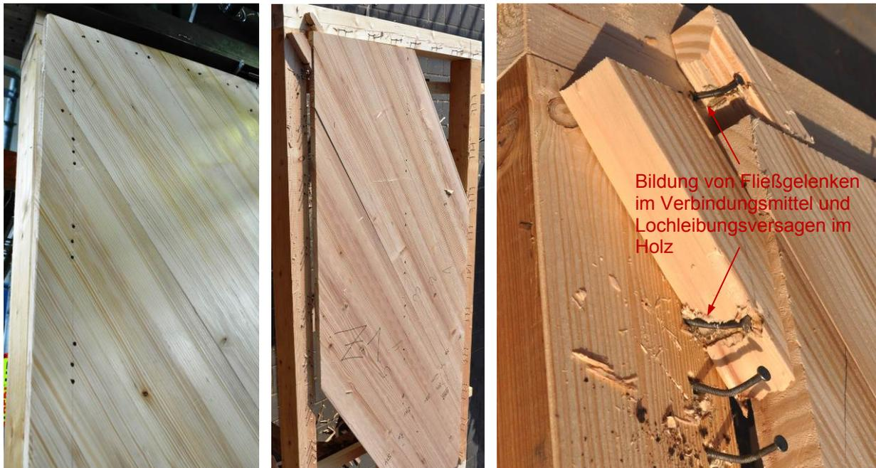
**Bild 11** Prüfkörper Z1 nach Versuchsdurchführung: Relativverschiebung zwischen Beplankung und Rahmen (links), geöffneter Prüfkörper (Mitte) und Detail der Rillennagelverbindungen (rechts)
