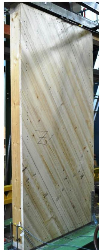
**Bild 5** Versuchsaufbau mit Anordnung der Messmittel (links) und Tafелеlement im Wandprüfstand vor Versuchsdurchführung (rechts)
