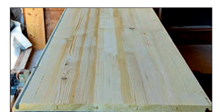
Für die GFM-Platte werden die Bretter längsseitig mit einer Schwalbenschwanz-Verbindung leimfrei zusammengefügt. Fotos: M. W. Lennartz (oben) und Massivholz Junker (unten)
